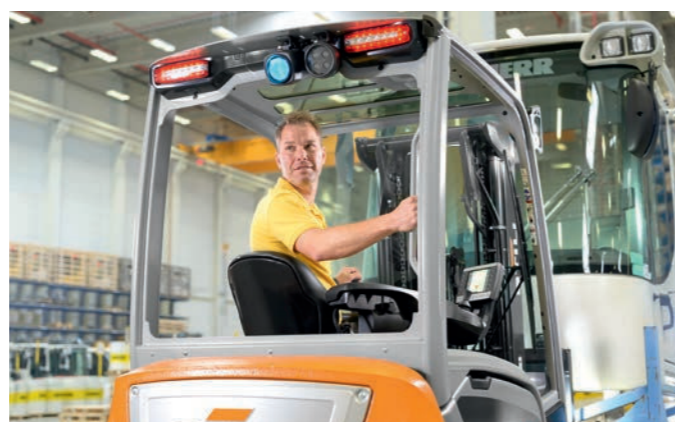
Draaibare stoelbeugel met optionele claxonbediening voor ergonomisch achteruitrijden
