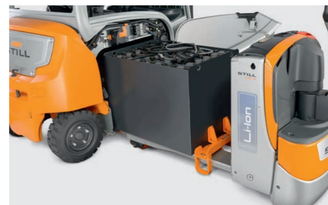
Batterij verwisselen met elektrische pallettruck
