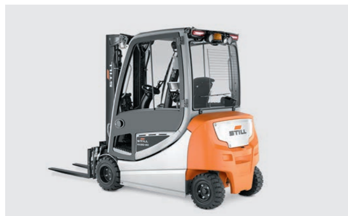
Versie met vier wielen met volledig gesloten bestuurscabine voor gebruik buiten
