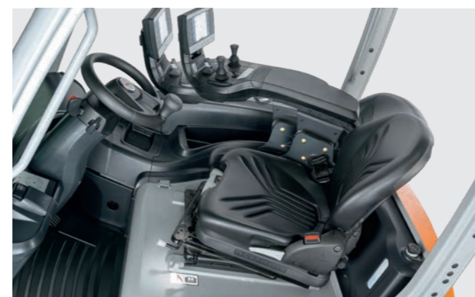
Draaistoel voor comfortabel achteruit rijden
