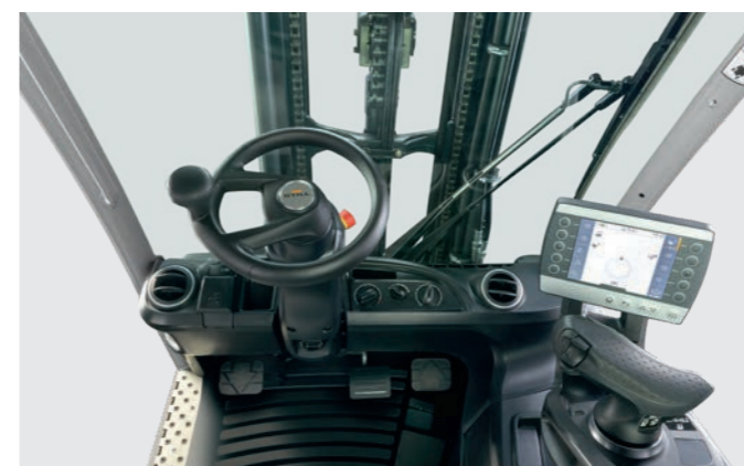
Werkruimte met display en Joystick 4Plus bediening en verwarming
