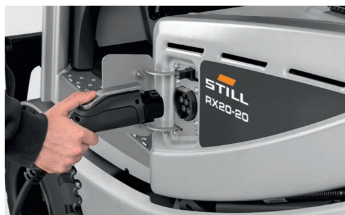
Optionele ingebouwde lader voor gedecentraliseerd opladen zonder batterijwissel
